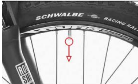
Ventili morajo biti usmerjeni neposredno proti srednji osi cestnega kolesa.
