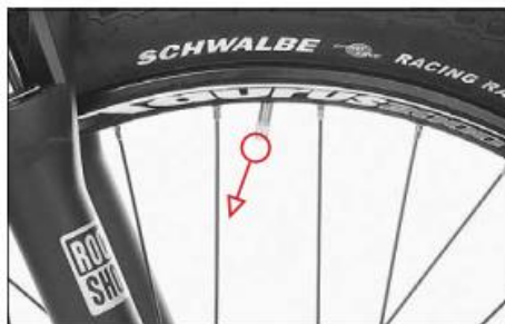
Ventil ni usmerjen proti prečnemu središču kolesa
