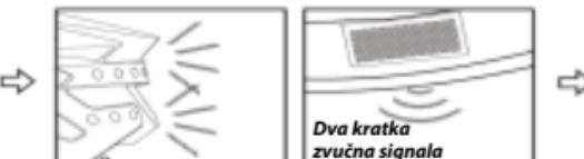
Kada bljesne svjetlo upozorenja i iz zvučnika kacige čujete dva kratka zvučna signala, to znači da se u blizini nalazi uređaj koji zahtijeva povezivanje s kacigom. (*Kacige bez Bluetooth zvučnika neće reproducirati te glasovne poruke.*)
