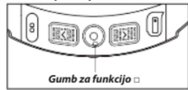
V 10 sekundah po pisku pritisnite gumb □ na čeladi in potrdite povezavo z napravo. Po pritisku gumba za desno ali levo na daljinskom upravljalniku Bling se pojavi signal za zavijanje levo ali desno.
