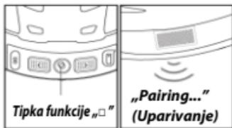
Dok je uređaj isključen, pritisnite i držite tipku „□“ dok ne čujete glasovnu poruku „Pairing...“ (Uparivanje).
