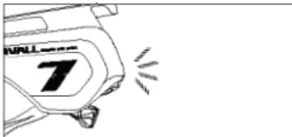
Nato bo zadnja lučka čelade še naprej utripala v načinu osvetlitve pred povezavo. Po uspešni povezavi lahko z BR80 nadzorujete signal za zavijanje v levo in desno.
