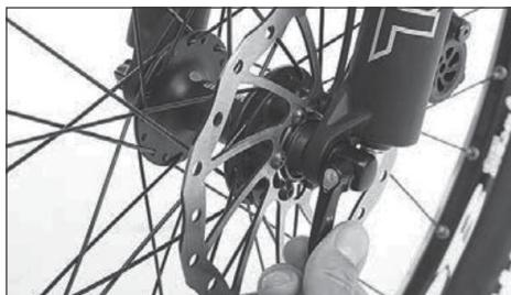
2. Matico obrnite v nasprotni smeri urinega kazalca, dokler se kolo ne odstrani iz okvirja ali sprednjih vilic brez kakršnega koli napora. Če matica pada iz vijaka se prepričajte, da ne izgubite malih vzmeti.
